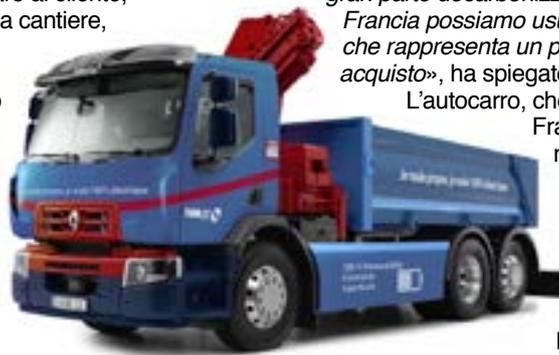
L'autocarro, che sarà utilizzato nella regione dell'Ile de France, può essere facilmente ricaricato nelle vicinanze dei cantieri o presso alcune stazioni di Parigi specifiche per i veicoli industriali. La ricarica parziale di un'ora (22kW) permette, ad esempio, al veicolo di guadagnare da 15 a 20 km di autonomia, confermando l'energia elettrica come la tecnologia ideale per l'uso urbano.
