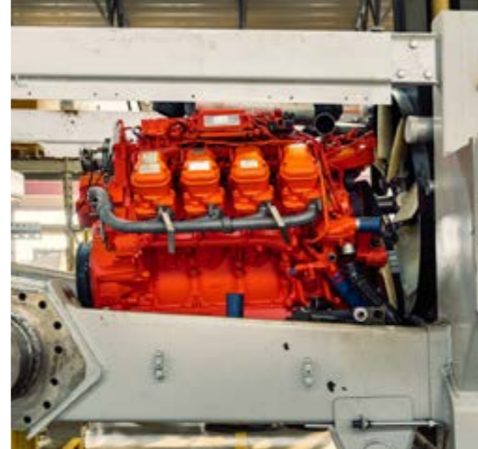
In apertura e, a destra, al lavoro in cantiere, il dumper DP 405 WD di Perlini da 40 tonnellate, motorizzato con un 12 litri Stage V di Scania (qui sopra, con l'inconfondibile livrea arancio). Gli Stage V svedesi equipaggiano la gamma di dumper Perlini, ad eccezione del 'peso massimo', il DP 905 WD.
