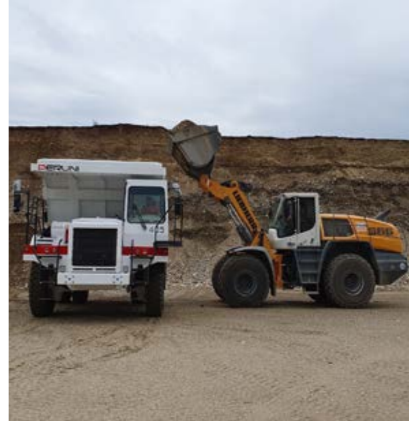
In apertura e, a destra, al lavoro in cantiere, il dumper DP 405 WD di Perlini da 40 tonnellate, motorizzato con un 12 litri Stage V di Scania (qui sopra, con l'inconfondibile livrea arancio). Gli Stage V svedesi equipaggiano la gamma di dumper Perlini, ad eccezione del 'peso massimo', il DP 905 WD.
