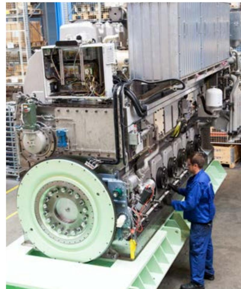
– 750 (potrebbero materializzarsi le decinazioni V14, V16 e V20, i 16 e 20 cilindri si spingeranno fino a 12 MW e serviranno per applicazioni terrestri) e 500/600 kW per cilindro utilizza gli iniettori pompa su tutta la linea, svariata disinvoltamente sui sistemi di alimentazione, dal gas al diesel. Il Vvt (Variable valve timing) collabora con l'iniezione per il riempimento dei cilindri calibrato in base al carico, alla pari del Cd (Computational fluid dynamics).
