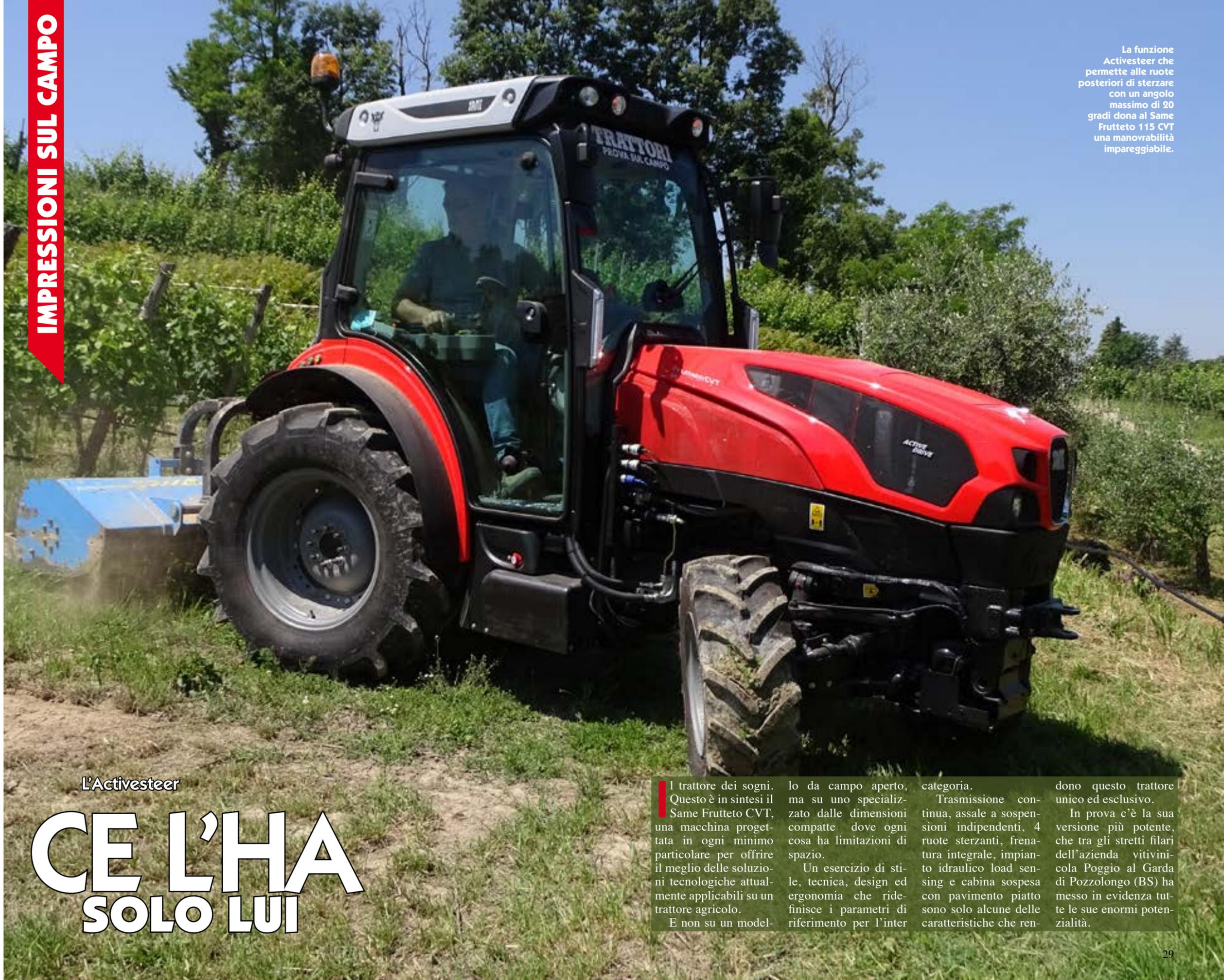
La funzione Activesteer che permette alle ruote posteriori di sterzare con un angolo massimo di 20 gradi dona al Same Frutteto 115 CVT una manovrabilità impareggiabile.
