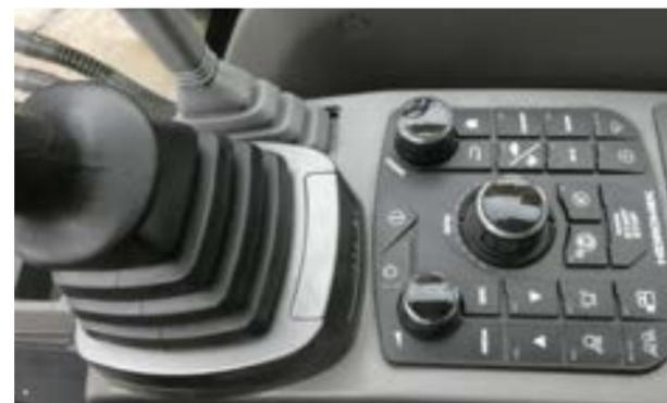
e della funzionalità. Il dialogo fra macchina e operatore avviene tramite il nuovo monitor touch-screen da 8 pollici. Sulla destra è presente sia il comando lama, collocato correttamente vicino al manipolatore, e poco più dietro, il centro comandi con il potenziometro e tutti i pulsanti per selezionare le mo-
