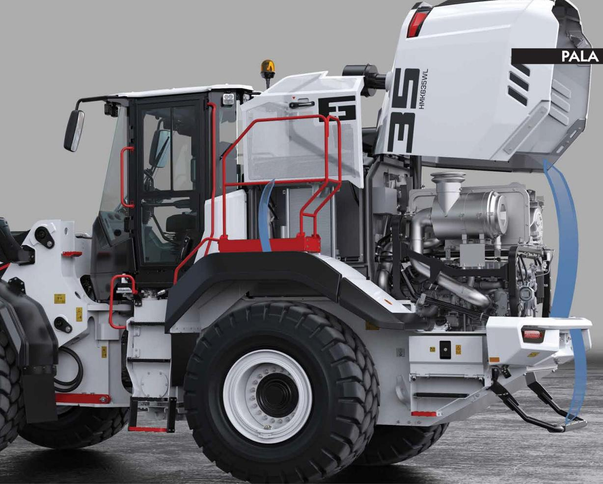
La posizione arretrata del motore permette di ottimizzare il bilanciamento della Hmk 635 WL, caratteristica che offre molti vantaggi dal punto di vista operativo.
