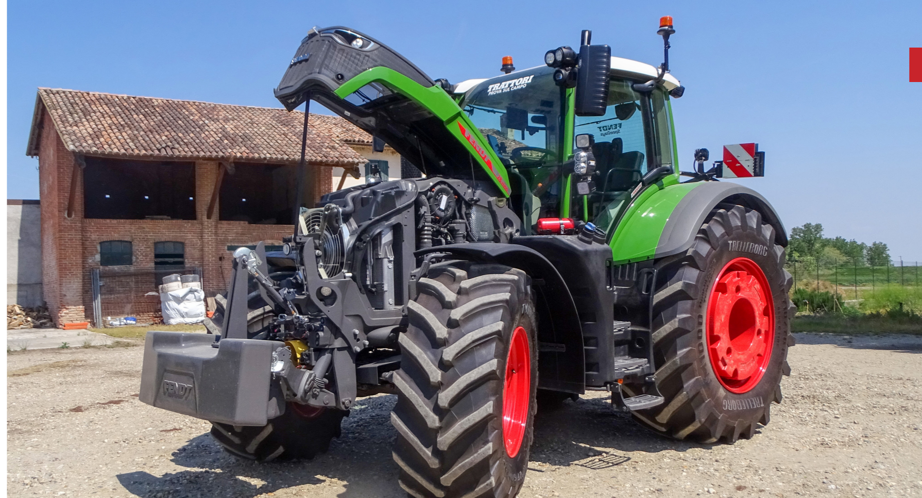
Il Fendt 728 Vario, che compare anche nelle pagine di seguito, è motorizzato dal Core75. È la stessa cilindrata unitaria del Core50, presentato ad Agritechnica. Questo motore si confronta con le altre unità da 5 litri che trovate nella tabella.
