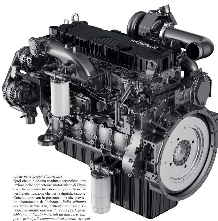
il blocco cilindri e la testata. Per le parti mobili, come punterie, pistoni e fasce elastiche, sono stati scelti materiali resistenti all'usura per migliorare la durata. Inoltre, l'adozione di un turbocompressore a due stadi nei sistemi di aspirazione e scarico non solo garantisce un aumento della potenza del 21% rispetto ai motori precedenti, ma migliora anche la coppia ai bassi regimi.
